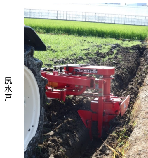
写真 オーガ式溝堀機
